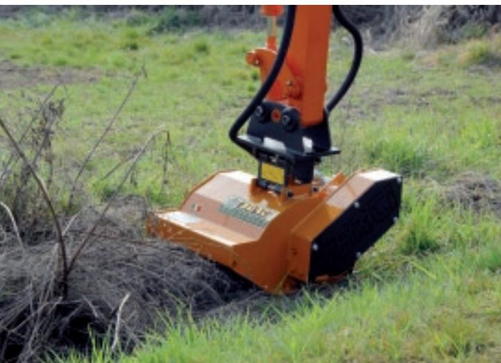
Testata trincante idraulica per mini-escavatori, con peso operativo compreso fra 1,5 e 2 tonnellate, adatta a trinciare erba, piccoli rovi fino a Ø 1 cm..
